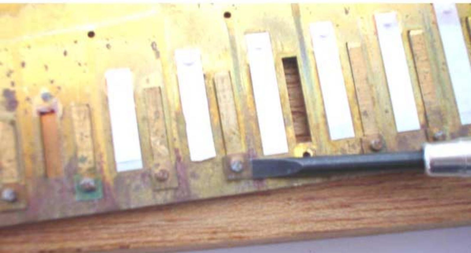
(注) 通常はリベットの頭とリードプレートが離れずにリベットが外れるが、時には離れてしまい、ドライバーの入る隙間ができないことがある。
