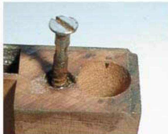
3. ボンドが固まると透明色に変わってくるが、固まりだしたら一度、ネジを途中まで入れて穴の形を整えておく。
